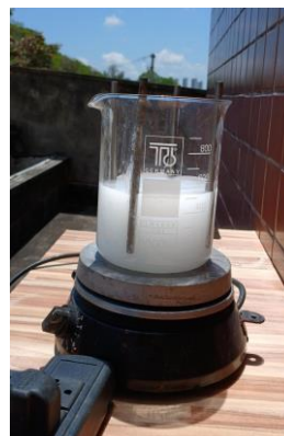
Figura 1: Esquema do sistema operacional: reator batelada com aletas e agitação magnética.
