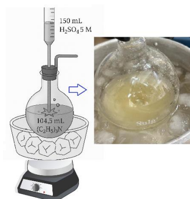
Figura 1. Esquema de produção do Líquido Iônico [TEA][HSO 4 ] em banho de gelo.
