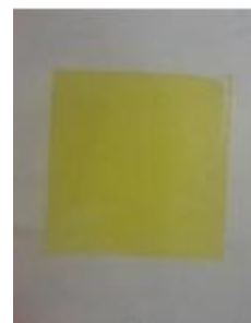
Figura 1: Eletrodo fotoânodo de \text{BiVO}_4 pelo método de eletrodeposição.
