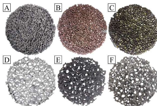
Figura 3. Espumas metálicas, sendo A, B e C: E1 recoberta antes da reação fotocatalítica, após reação fotocatalítica e após regeneração, respectivamente; D, E e F: E2 recoberta antes da reação fotocatalítica, após reação fotocatalítica e após regeneração, respectivamente.
