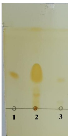
Figura 4. Cromatografia de camada delgada das amostras de: (1) ácido oleico, (2) reação com DES como solvente, e (3) éster obtido segundo Gonçalves et al. [3].
